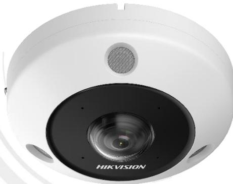
DS-2CD6365G1-IVSは、360度のパノラマ画像を提供できる魚眼ネットワークカメラです。プログレッシブキャンCMOSセンサーにより、最大2,560×2,560の高解像度画像を提供します。最大20種類のライブビュー表示モードは、3つのマウントタイプに対応しており、さまざまなユーザーの好みに対応します。独立して制御される3つのIRライトは、15 mの範囲を提供し、低照度またはゼロ照度環境でも良好な視界を提供します。
